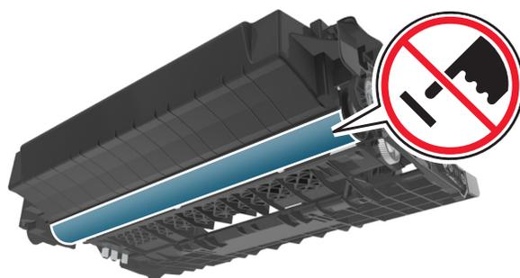
**6** Inserire l'unità immagini nella stampante allineando le frecce sulle guide laterali dell'unità immagini con le frecce sulle guide laterali all'interno della stampante.
